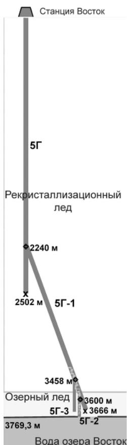
Рис. 4. Схема глубокой скважины 5Г, пробуренной на станции Восток. Отмечены точки отклонения и образования новых стволов скважины 5Г-1, 5Г-2, 5Г-3.
