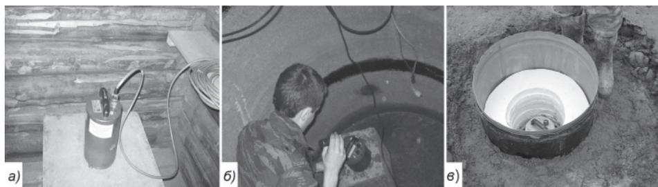
Рис. 2. Пункты seismicких наблюдений в виде погреба (а) и колодца (б) на примере организации Архангельской seismicкой сети и пример организации бюджетного seismicкого сооружения (в).
