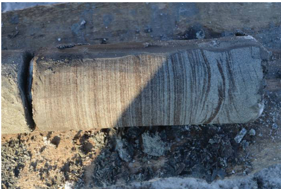
Рис. 4. Керн подрусловых песчаных аллювиально-дельтовых толщ обычно насыщен частыми слоями органического материала. Сква. 3с-16.
