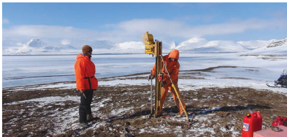
Рис. 3.3.1. Бурение скважины с помощью установки УКБ-12/25 в долине Грёндален в мае 2017 г. (фото В. Демидова).
