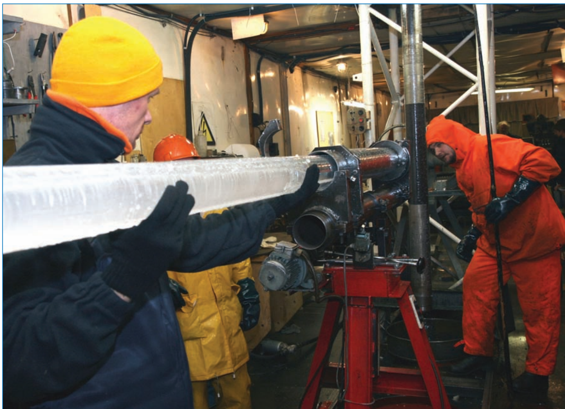
Керн льда озера Восток, поднятый буровым снарядом с глубины 3720 м
