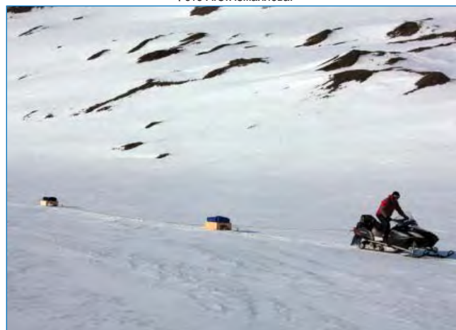
Выполнение радиолокационного зондирования ледника Тунге. Фото А.С.Измайлова.
