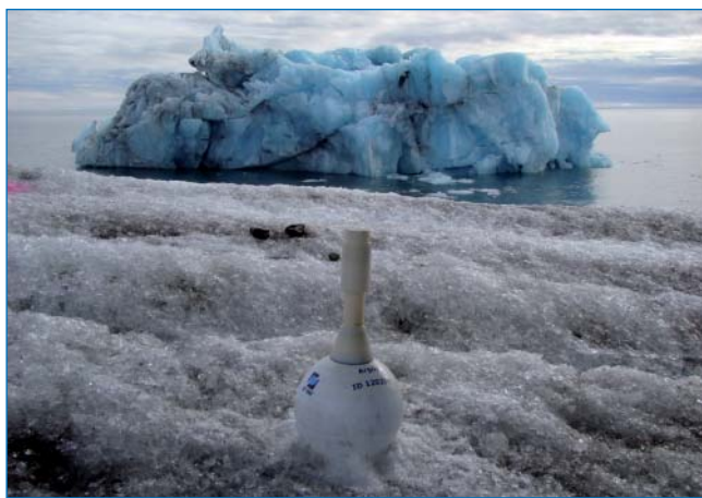
Автономный буй ARGOS, установленный на айсберге в августе 2012 г. в Карском море.
