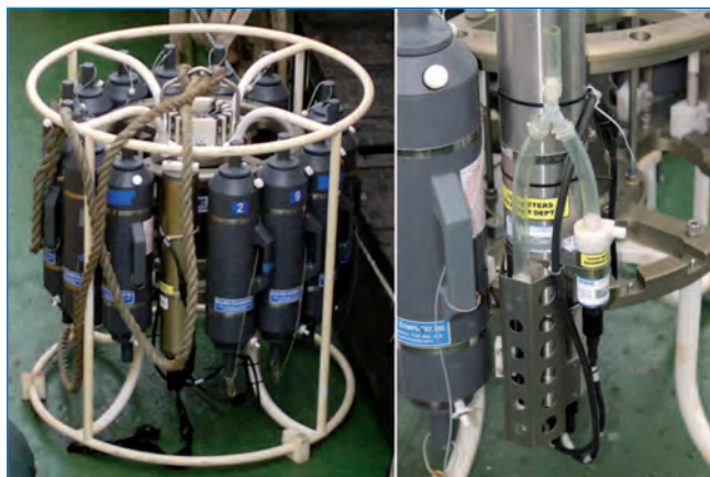
Комплекс для отбора проб воды SBE 32c (слева) и CTD-зонд SBE 19 plus (справа). Фото М.Махотина.
