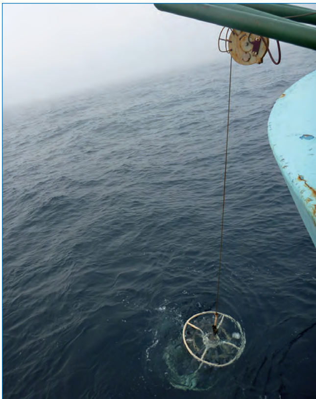
Спуск розетки с батометрами – отбор воды с поверхностного горизонта. Фото А.В.Весман.
