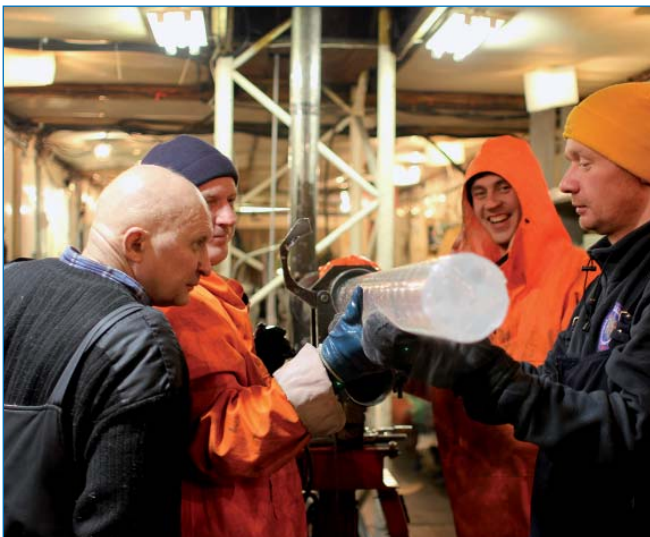
Станция Восток, январь 2013 г. Извлечение ледяного керна длиной более 2 м из бурового снаряда.
