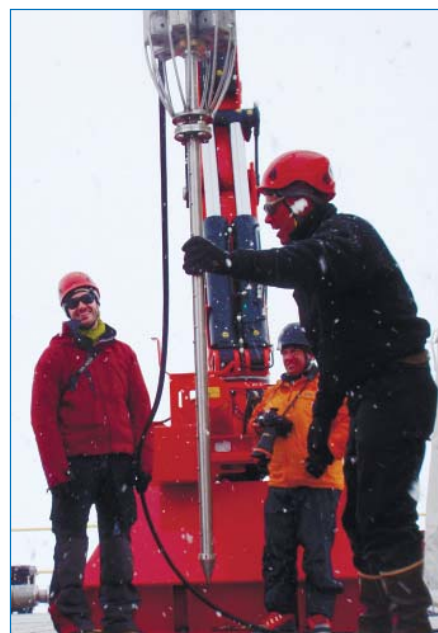
Физико-океанографический модуль и геотермальный датчик перед погружением в скважину.
