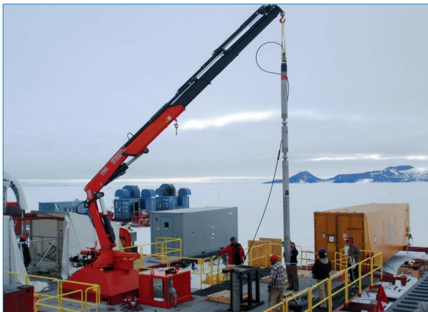
Физико-океанографический модуль и геотермальный датчик перед погружением в скважину.
