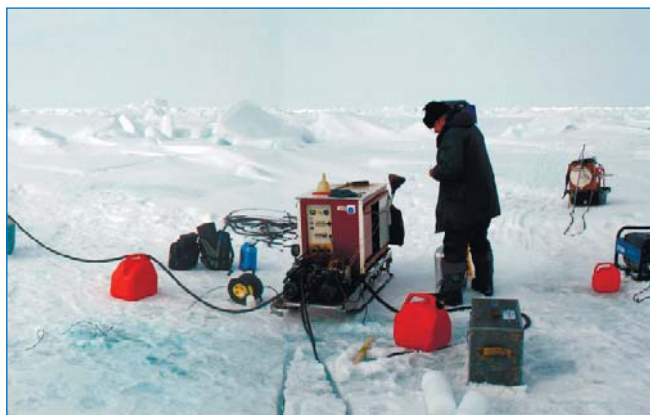
Установка УВБЛ-2 для водяного термобурения.
