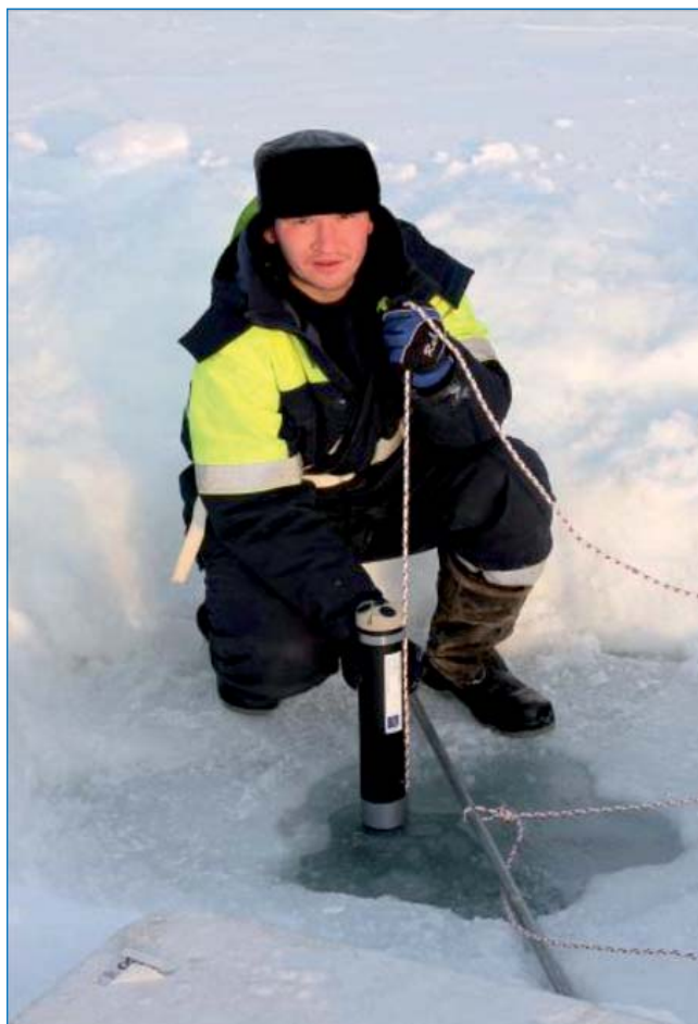
Сотрудником АНИИИ А.А.Балакин устанавливает ADCP Nortek Aquadopp Pro.
