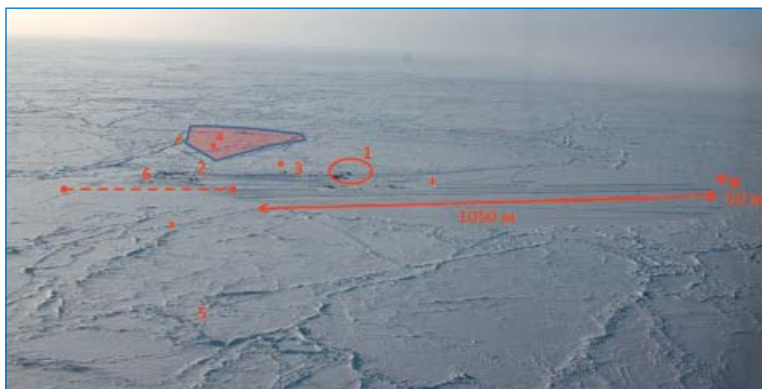
Ледовая база Барнео (фотосъемка с борта вертолета МИ-8 20 апреля 2013 г.). 1 – лагерь базы с указанием расположения ВПП (1050×50 м), 2 – площадка вертолетов МИ-8, 3 – гидрологическая палатка, 4 – поле расстановки дрейфующих буев, 5 – площадка выполнения работ по морфометрии торосов, 6 – ось расстановки сейсмографов, * – места выполнения георадарных съемок и взятия кернов льда.
