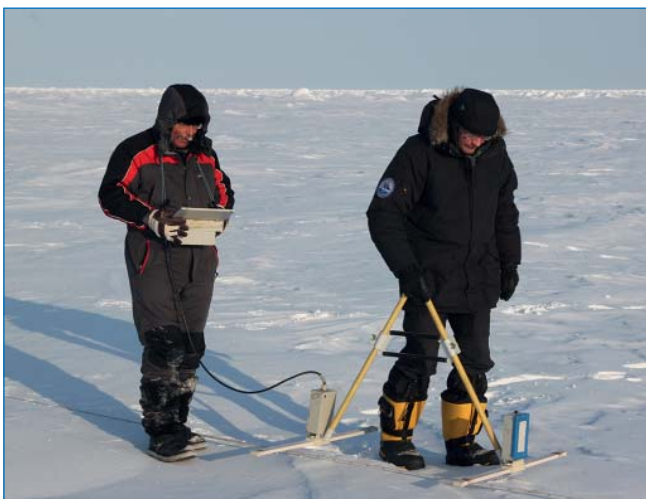
Выполнение профильных съемок морского льда с помощью георадара «Лоза» В.Смоляницким и П.Хлебопашевым (слева) и пример профильных наблюдений (справа).
