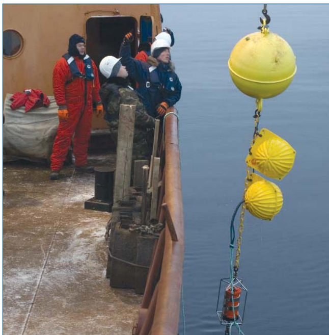
Постановка донной океанографической станции в море Лаптевых на годовой срок наблюдений (слева) и подготовка зонд-батометра к STD-измерениям и отбору проб воды пластиковыми батометрами (справа).
