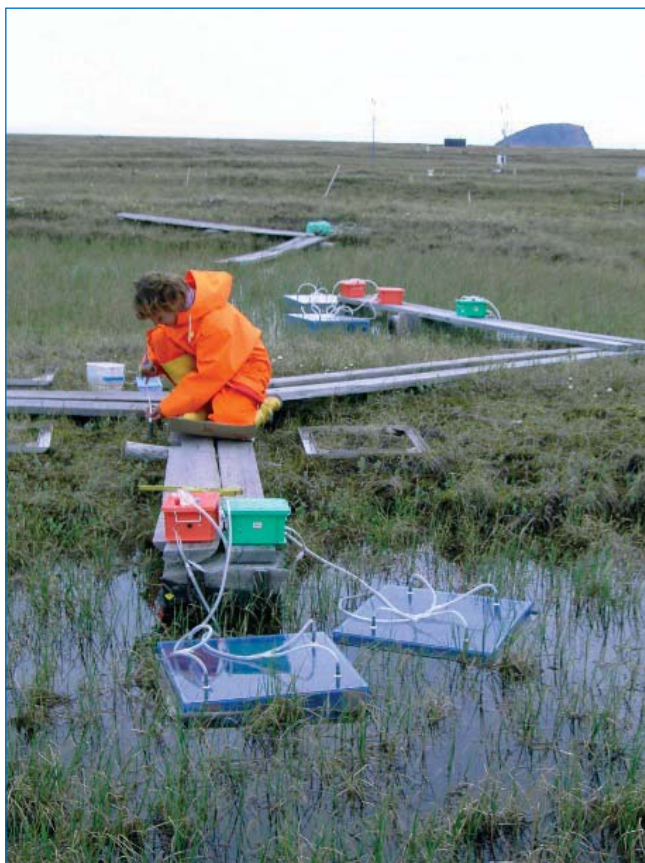
Отбор проб газа с использованием специальных «ловушек» с целью дальнейшего определения содержания метана в пробе на полигоне о. Самойловский.
