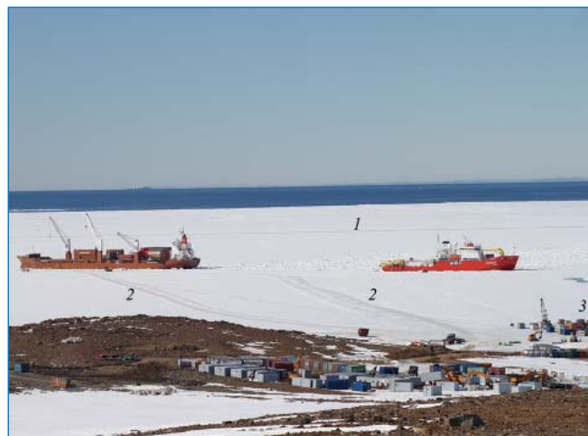
«Суомиграт» (слева) и «Араон» при выгрузке на припай в заливе Гондвана 16 декабря. 1 – приливная трещина, 2 – ледовые дороги; 3 – контейнеры на припае; 4 – жилые домики и контейнеры на берегу.
