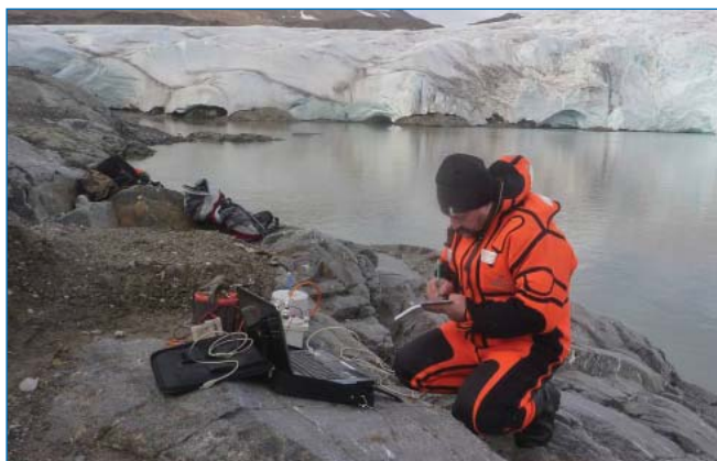
Установка сейсмометра на выходах коренных пород у ледника Норденшельда.
