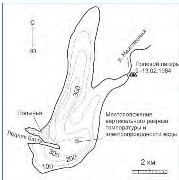
Первая батиметрическая схема оз. Радок, составленная по данным работ с 10 по 12 февраля 1984 г.
