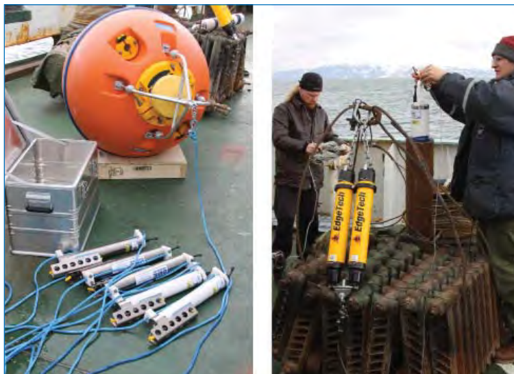
Монтаж притопленной буйковой станции на НИС «Профессор Молчанов»: слева – буй положительной плавучести со встроенным измерителем скорости и направления течений (ADCP), четыре измерителя температуры и солёности (SBE37), справа – два размыкателя и груз. Фото М.С. Махотина.
