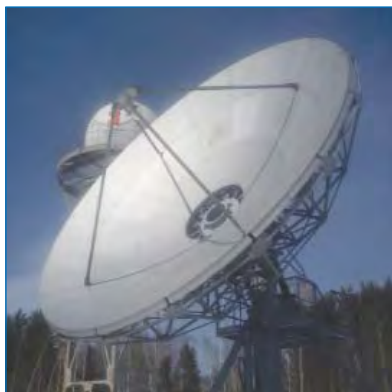
Антенна станции приема данных КА «Электро» в филиале НИЦ Планета в Новосибирске.
