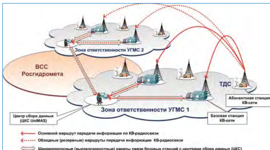
Схема организации распределенной сети КВ-радиосвязи.
