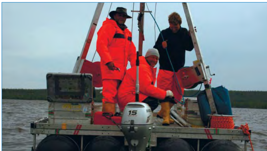
Отбор кернов донных отложений с плавучей платформы на оз. Кютюнда, Северная Якутия, 2010 г.
