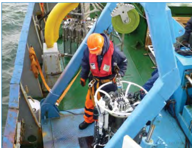
Океанографический пробоотборный комплекс SBE 32c.
