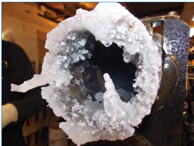
Коронка бурового снаряда после вскрытия озера.
