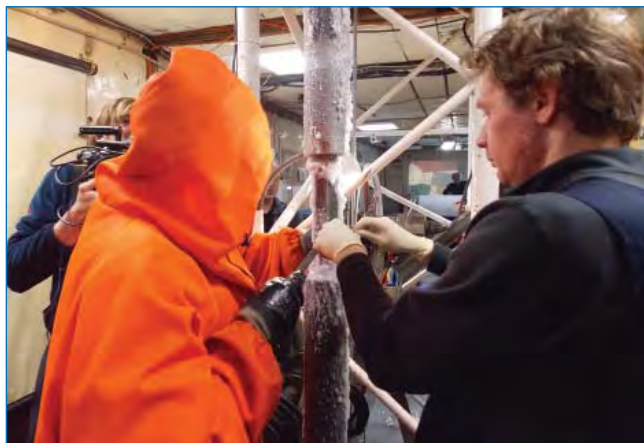
Отбор пробы намерзшей на буровой снаряд воды.
