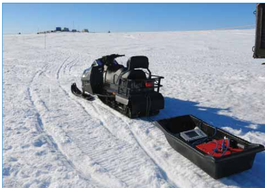
Рис. 7. Проверка выбранной площадки под ВПП на отсутствие внутренних трещин или полостей с помощью радиолокатора GSSI SIR 3000.
