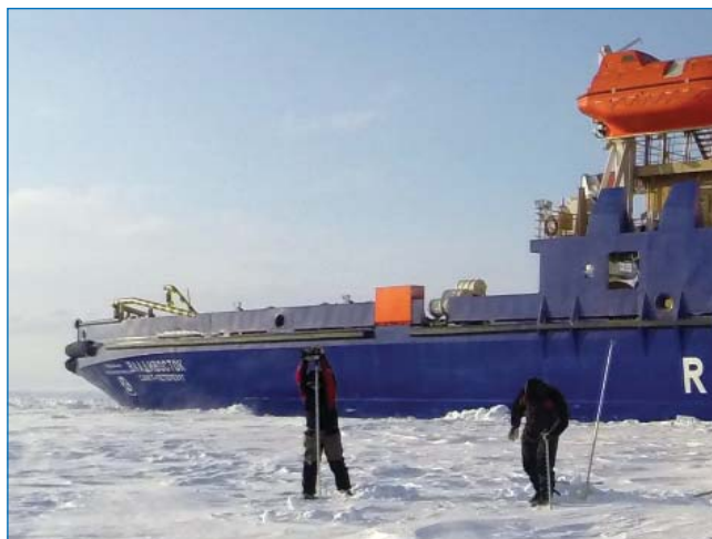
Бурение скважины для измерения толщины льда у борта ледокола «Владивосток» на полигоне № 1.
