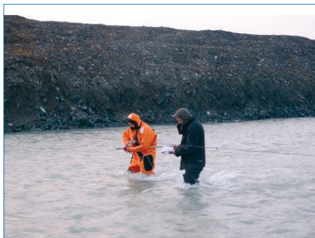
Измерение расхода воды на реке Останцовая.
