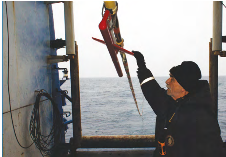
Устройство контроля глубины DigiBIRD на сейсмической косе DigiSTREAMER. Фото А.Ю. Казанкова.
