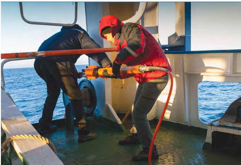
Подъем на борт буксируемой гондолы магнитометра-градиентометра SeaSPY-2. Фото П.И. Лулева.
