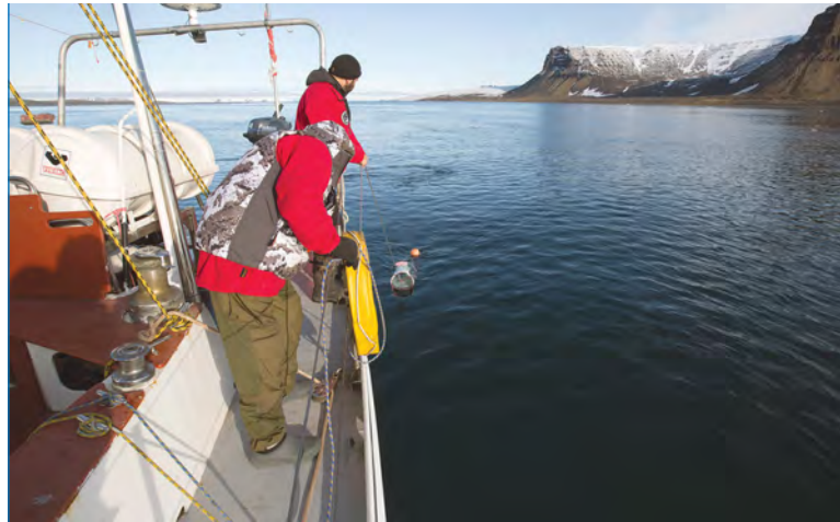
Отбор пробы поверхностной воды планктонной сетью Джеди с борта экспедиционного судна «Альтер Эго» ведут Александр Чичаев и Михаил Карганов. Фото И.Г. Тимина.
