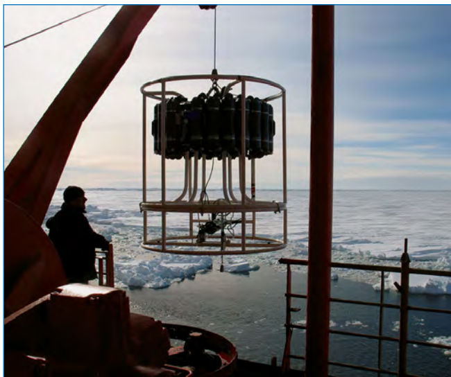
Океанографические работы в Южном океане зондом «Sea Bird 911+». Фото Н.Н. Антипова
