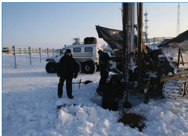
Установка сейсмодатчика на полуострове Ямал. Фото из архива Департамента по науке и инновациям ЯНАО
