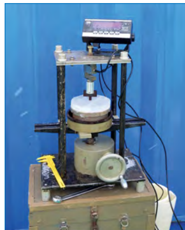
Испытания изгибной прочности льда на малых образцах
