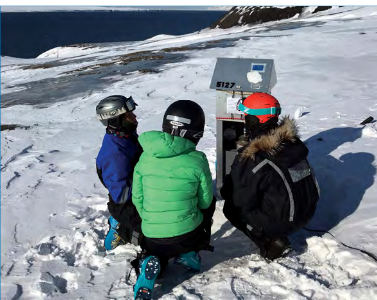
Установка насоса для отбора воздуха
