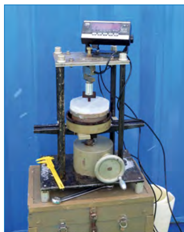
Испытания изгибной прочности льда на малых образцах
