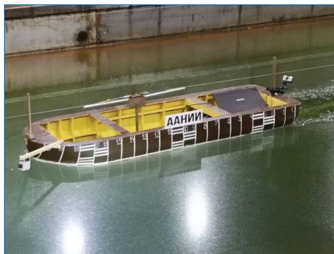
Модельные испытания ледопроницаемости ЛСП в сплошном ровном льду. Фото Н.А. Крупиной
