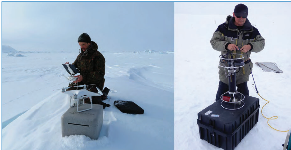
Подготовка к запуску БПЛА мультироторного типа (слева) и гидролокатора кругового обзора (справа) к работе
