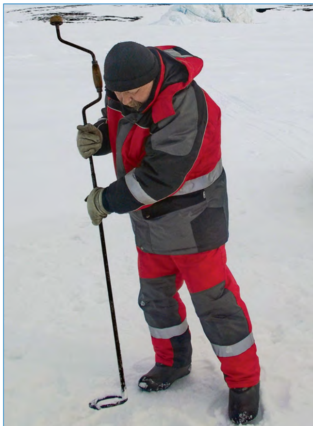
Рис. 4. Бурение льда кольцевым буром Черепанова
