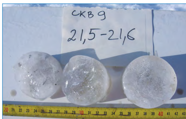
Керны из ледяного тела булгуньяха в поперечном сечении. Видны единичные вкрапления темного глинистого материала
