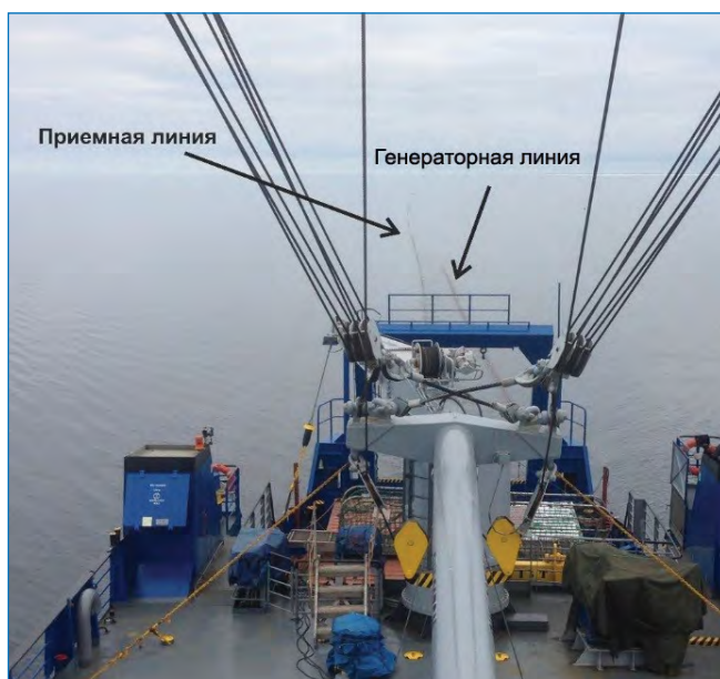
Рис. 6. Морские геофизические работы методом ЗСБ на Приамальском шельфе
