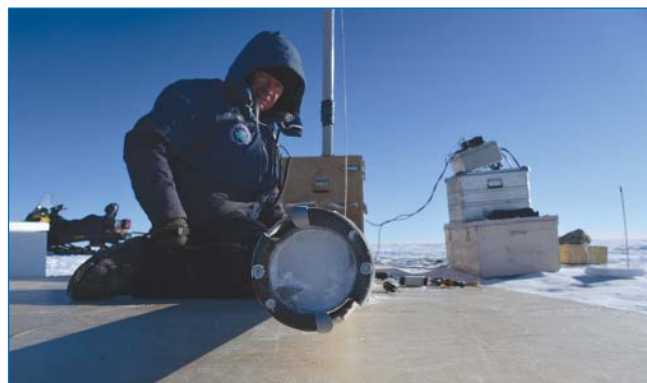
Рис. 4. Скважина VK19. Буровой снаряд с вновь добытым керном поднят на поверхность. Фото А.Н. Верес
