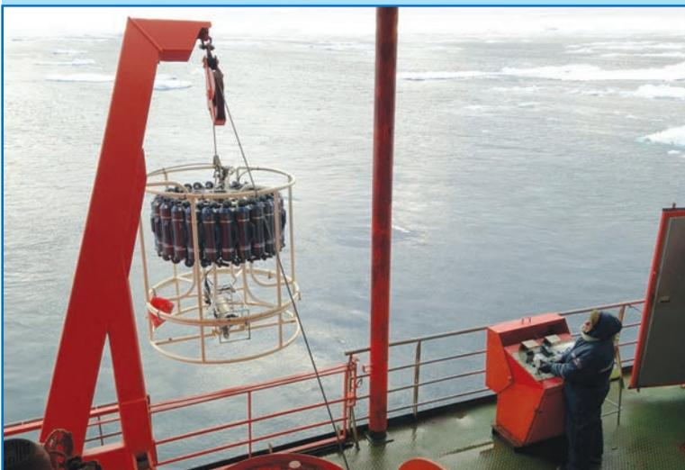
Экспедиция «Трансарктика-2019». Зондирование на выносной станции в разбуренной майне
