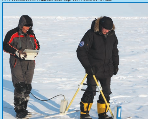
Выполнение профилейных съемок морского льда с помощью георадара «Лоза» В. Смоляницким и П. Хлебопашевым. Ледовая база Барнео. Апрель 2013 года
