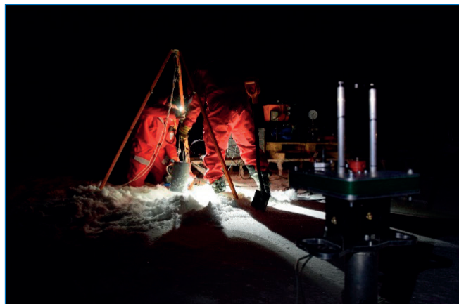
Измерение локальной прочности льда
