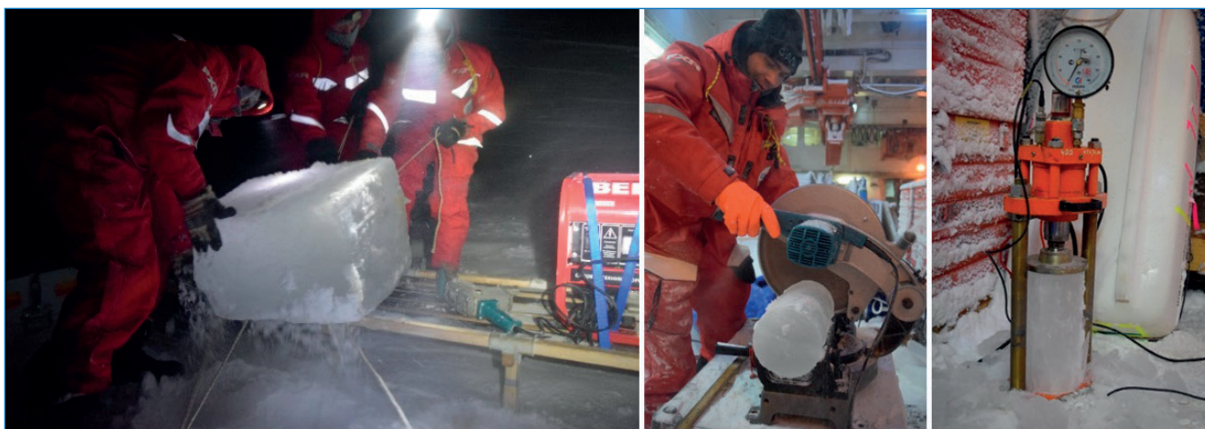
Измерение прочности льда на одноосное сжатие
