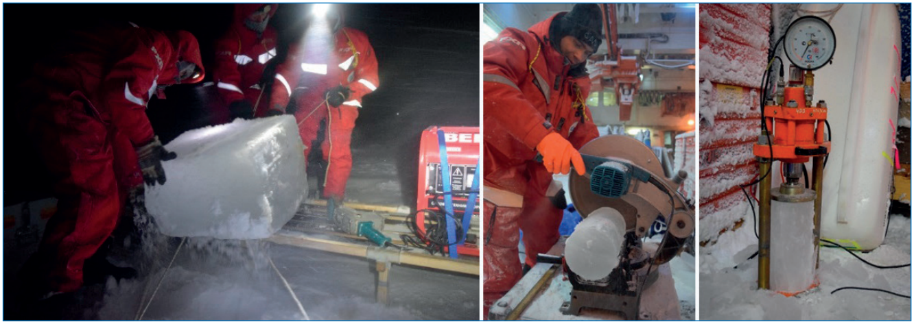
Измерение прочности льда на одноосное сжатие
