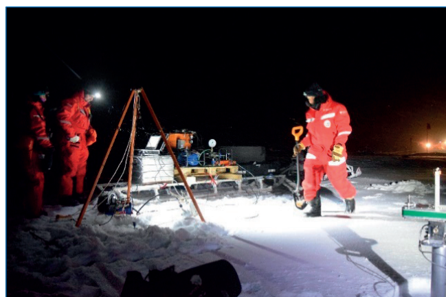
Измерение локальной прочности льда
