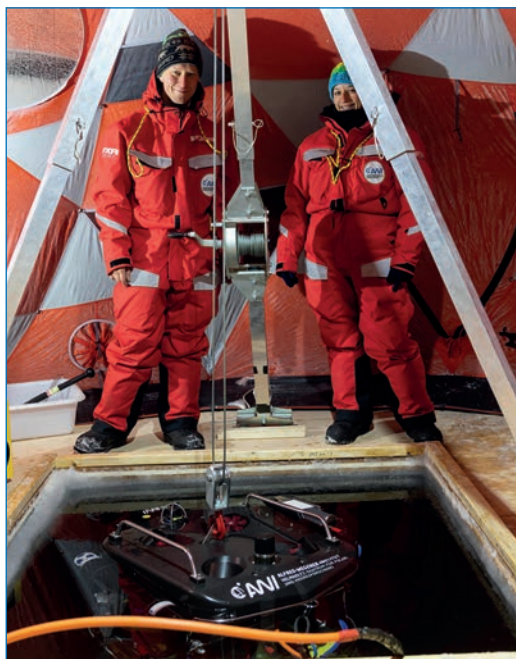
Аппарат Beast для подводных исследований ROV (верхнее фото) и его погружение в воду (нижнее фото). Фото М. Николауса
