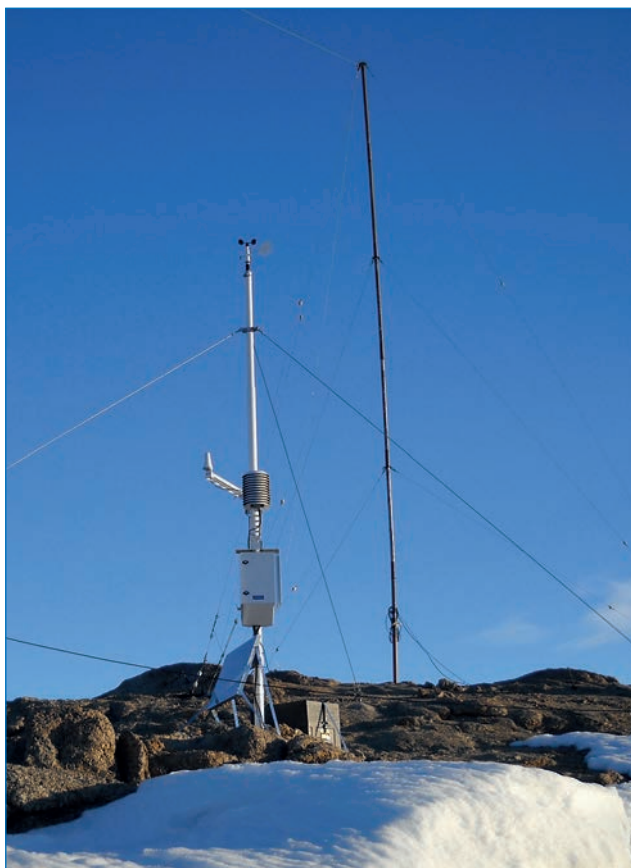
Рис. 3. Автоматическая метеорологическая станция, установленная на полевой базе Дружная-4
