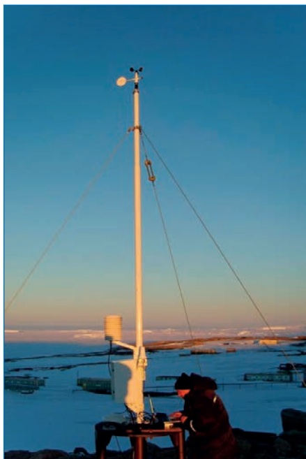
Рис. 1. Первая российская автоматическая антарктическая метеорологическая станция на базе MAWS 110, установленная на полевой базе Молодежная
