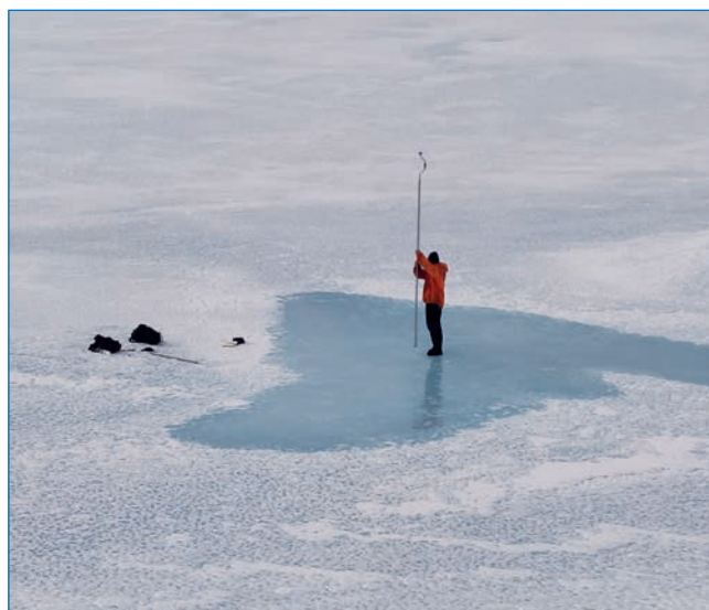
Рис. 2. Бурение льда на оз. Геологов. На поверхности льда видна изливающаяся из скважины солоноватая вода
