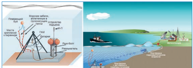
Рис. 5. Вариант реализации платформы с всплывающим буйем, оснащенной модемом гидроакустической связи и механизмами для подъема оборудования
