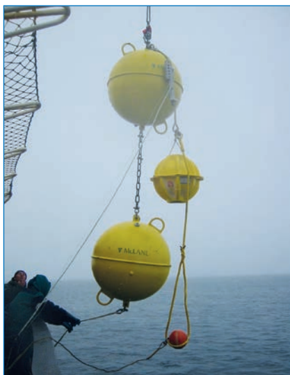
Постановка долговременной заякоренной ПАБС в экспедиции АВЛАП/NAVOS-2006 (слева) и вмораживаемого автоматического профилометра (ИТР) в экспедиции АВЛАП/NAVOS-2013 (справа). Фото из архивов ААНИИ
