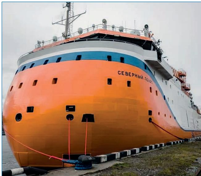
Безопасность судна гарантирует особая форма корпуса, которая оптимальным образом распределяет нагрузку от сжатия, фактически выдавливая судно на поверхность льда
