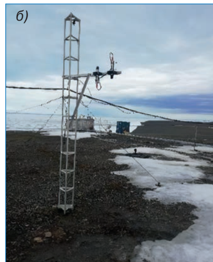
Рис. 2. Датчики на территории метеоплощадки НИС: а) крепление на штанге датчиков приходящей и отраженной солнечной радиации; б) общий вид стойки и подстилающая поверхность под датчиками после снеготаяния
