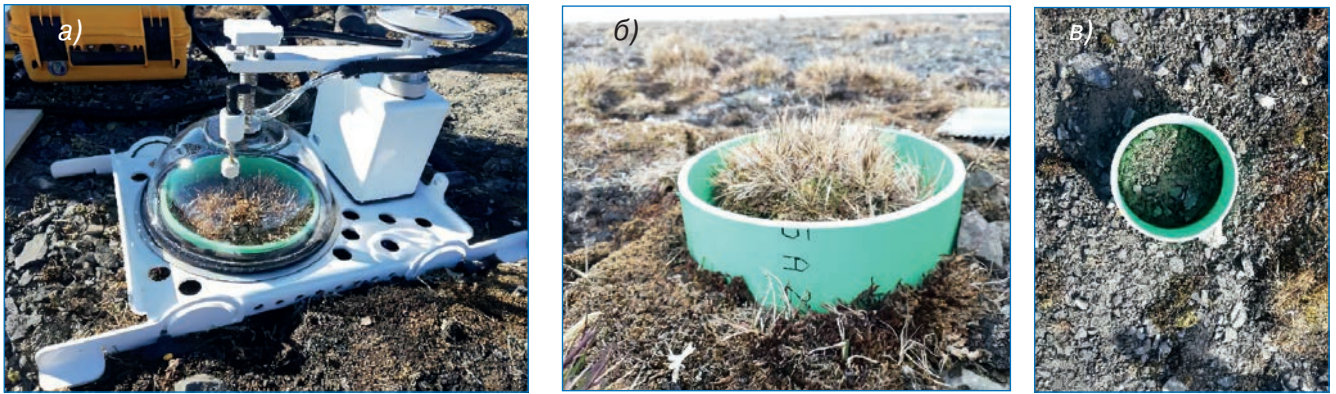
Рис. 5. Локации измерений потока углекислого газа: а) общий вид камеры Li-Cor 8100-104 во время измерений; б) на увлажненном участке, покрытом растительностью; в) на глинисто-каменистой поверхности
